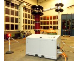
GIS Test Set 540kV
